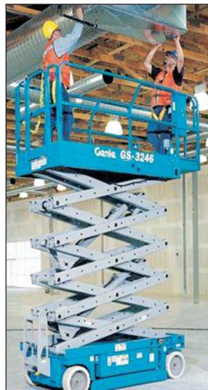
Piattaforma di lavoro mobile elevabile semovente a pantografo (A3)
